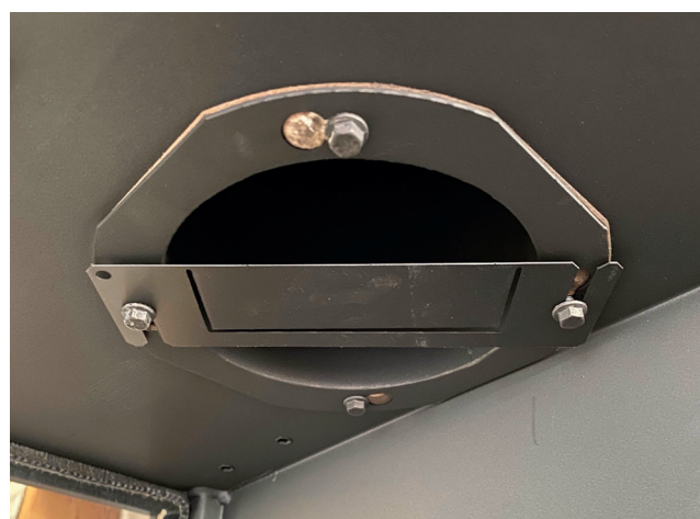
2. Installez le restricteur selon la forme indiquée, puis serrez les deux boulons en diagonale.
