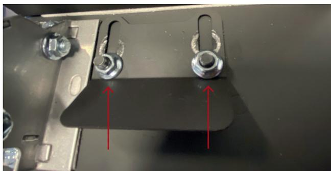
Le venturi des brûleurs secondaires doivent être complètement ouverts, sans plaques de recouvrement installées.
