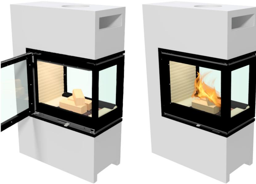
Il est important que les trois morceaux de bois de bouleau soient placés au centre du poêle et conformément aux instructions. Placez deux des bâtons les plus lourds au fond, espacés de 2 à 3 cm. Placez le troisième bâton en diagonale sur les deux autres.
