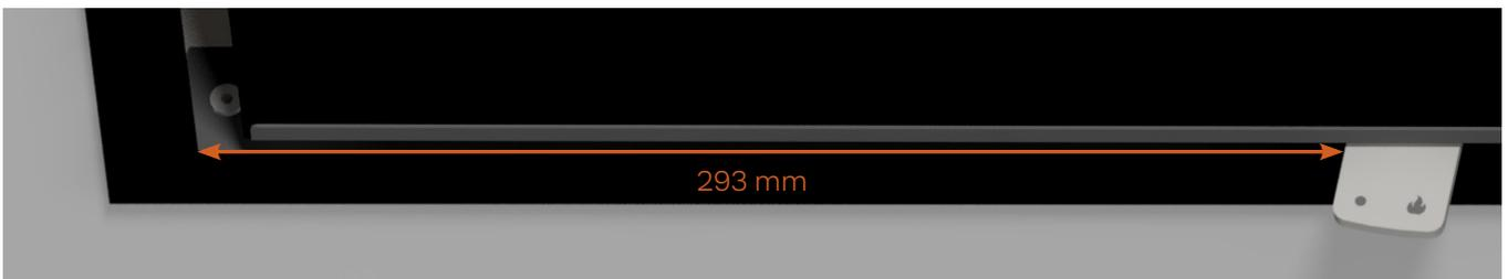
\*Le réglage précis du registre entre la position centrale et la position fermée est de 293 mm entre le bord intérieur du cadre et le bord de la poignée du registre\*.
