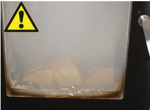
**Vermeiden Sie schwere Rauchemission — es besteht die Gefahr einer Abgasexplosion.**
