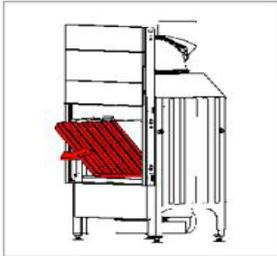
**1.** Entfernen Sie das Seitenblatt aus Skamol.
