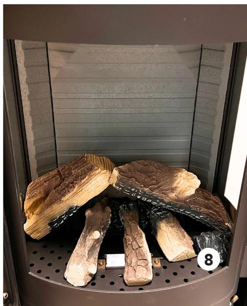
11. Parsemez 1 sachet de copeaux de braise à l'avant de la chambre de combustion. Assurez-vous de ne pas couvrir la zone pilote et les trous qui s'y trouvent. La moitié du deuxième sac peut être utilisée derrière le brûleur (facultatif).
