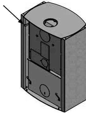
7. Réinstallez le panneau arrière et insérez les 4 butées fournies, 2 de chaque côté. Placez la pierre supérieure sur le poêle en veillant à ce que les butées de la pierre latérale correspondent avec les trous de repérage sur la plaque supérieure.
