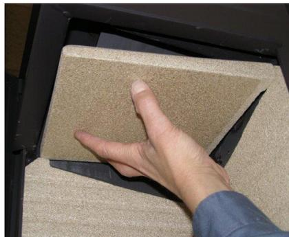
La plaque d'acier pose sur deux clous derrière et devant sur 2 tenons de la garniture tenons dans la garniture.
