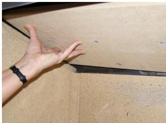
Enlevez la plaque de déflexion en la soulevant et en la faisant basculer sur l'extrémité. Enlevez doucement la plaque de déflexion.
