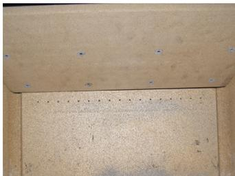
Le dispositif d'évacuation de fumée consiste en une plaque de déflexion surmontée d'un tuyau d'évacuation. Ces pièces, vissées ensemble, sont toutes deux fabriquées en vermiculite. Maniezlez avec soins.
