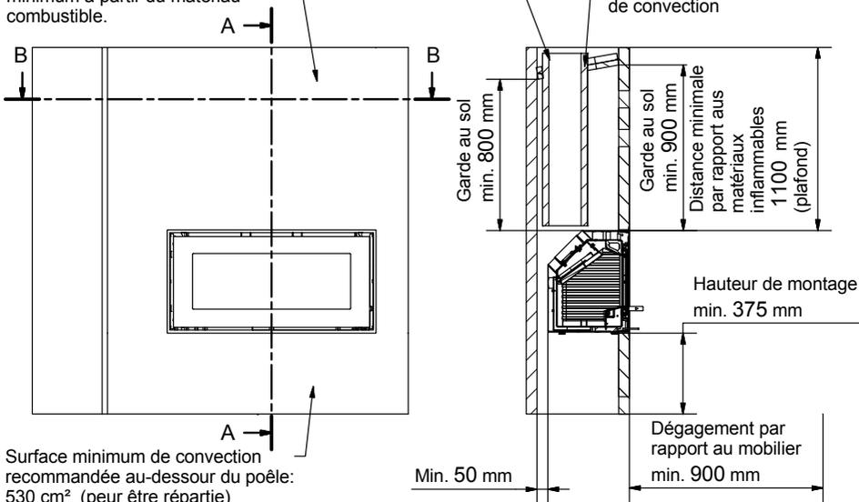
Surface minimum de convection recommandée au-dessous du poêle: 530 cm<sup>2</sup> (peur être répartie)
